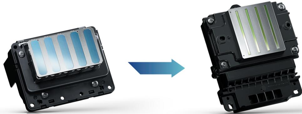
打印速度的提升，并没有以牺牲打印品质作为前提。爱普生PrecisionCore™ Micro TFP微压电喷头的精确喷射技术可以减少工程图的线条边缘的毛刺现象，即使在斜线、曲线等对线条精度要求很高的图形输出上，也能够呈现整齐而平滑的边缘，精度可达70 μm。
